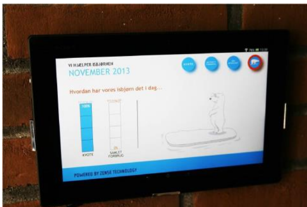
Figur 1 – Skærmen placeret i huset til monitorering af forbrug i forhold til kvote
